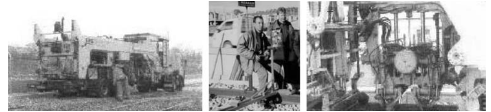
Şekil 2: Buraj Makinası ile Ölçüm ve Ray Düzeltmeleri
