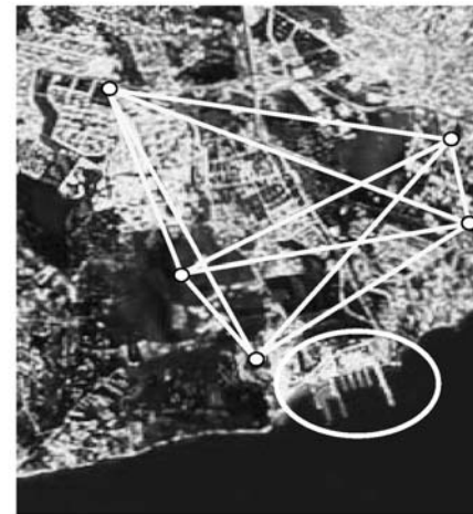
Şekil 4. Heyelan izlemesi yapılan bölge ve GPS referans ağı
