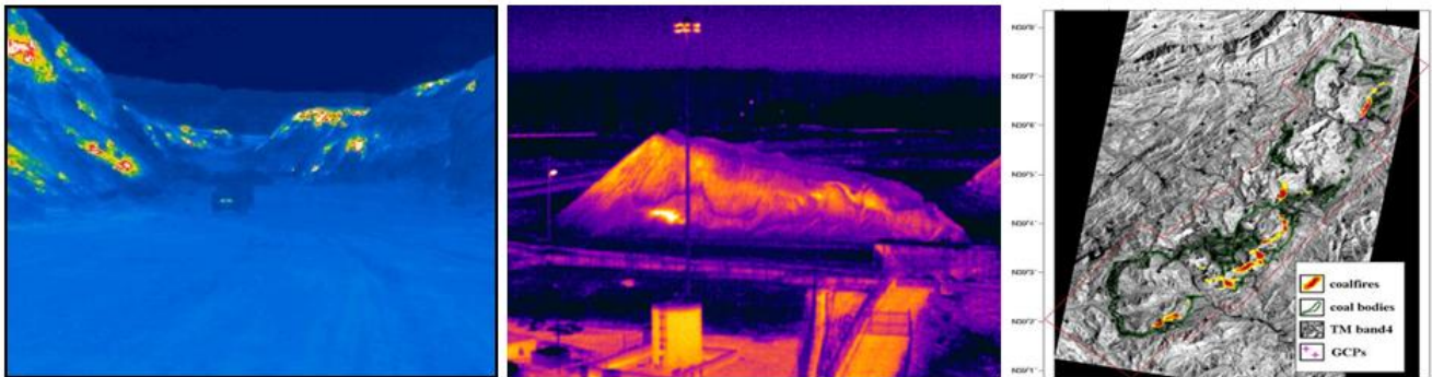
Şekil 2: Kömür Stok Yangınlarının termal görüntülerde ve Landsat 5 TM görüntüsü üzerinde proseslenmiş görüntüsü (Snall, 2011, Prakash vd., 2001).
