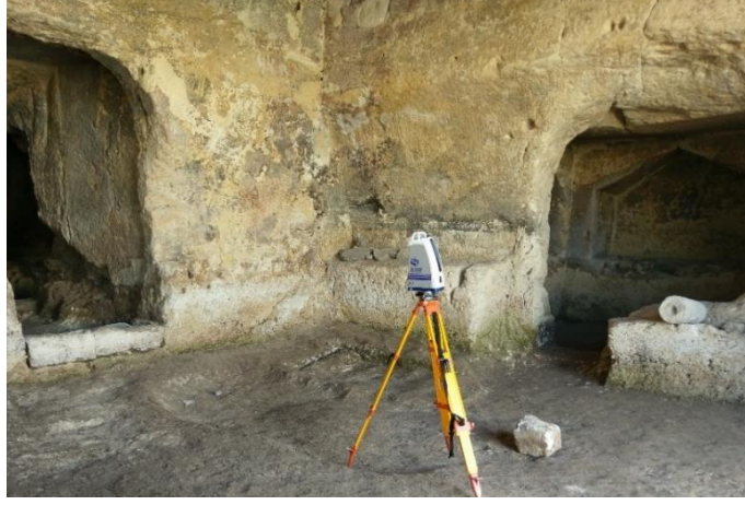
Şekil 3. Stonex x300 Lazer Tarama Cihazı
