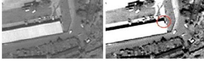
Şekil 2: Orijinal (sol) ve kontrast genişletmesi (sağ) yapılmış görüntülerde bina köşesinin YKN olarak seçilmesi (Jacobsen, 2006)
