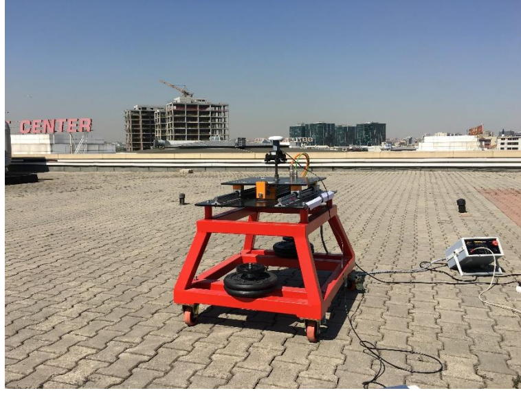
Şekil 4. Üretilen sistem ile yapılan sarsma tablası testleri
