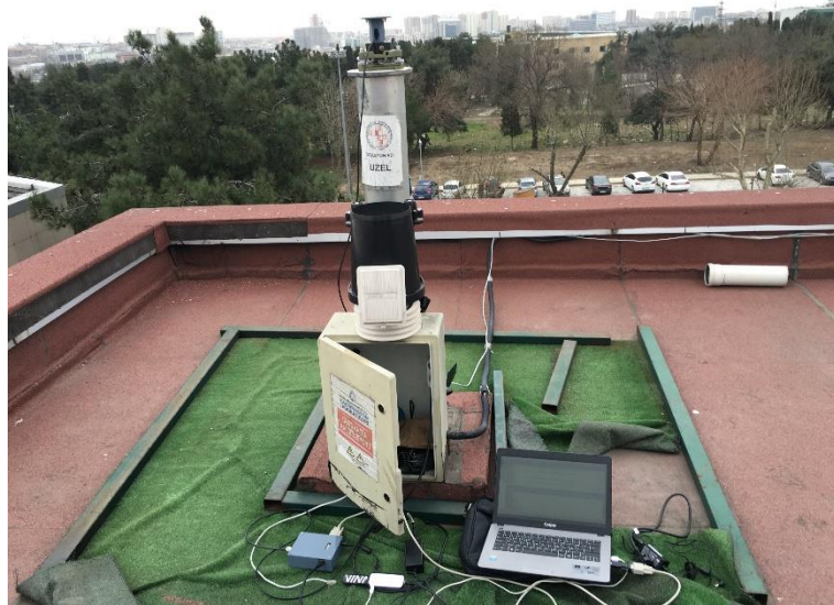
Şekil 4. Üretilen sistem ile yapılan jeodezik testler
