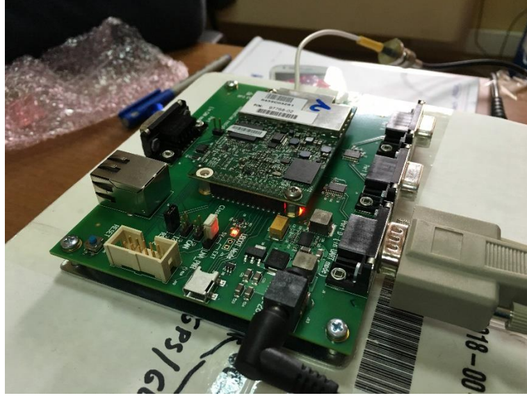
Şekil 3. Elektronik devre ile entegrasyonu yapılan GNSS board.
